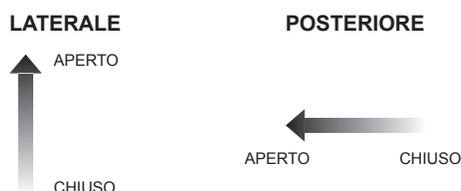
! È possibile aprire o chiudere il flusso dell'aria, inserendo la chiave nelle apposite fessure presenti sul top superiore, senza rimuovere parte del rivestimento della stufa.
