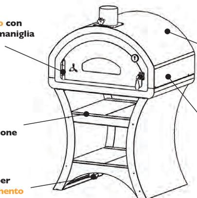
Doppia camera con **coibentazione** per evitare dispersioni di calore
