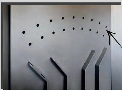
Sistema a foratura per l'immissione di ossigeno preriscaldato nella camera di combustione
